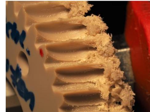
Unterschiedliche Schäden an Kunststoffzahnradern
